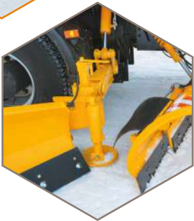
Опоры скольжения для предохранения дорожного полотна
