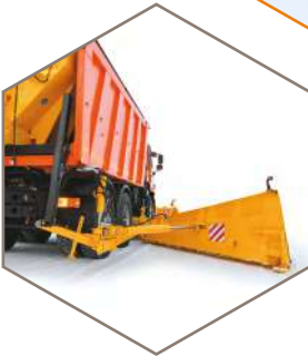
Усиленное исполнение задней части крыла отвала
