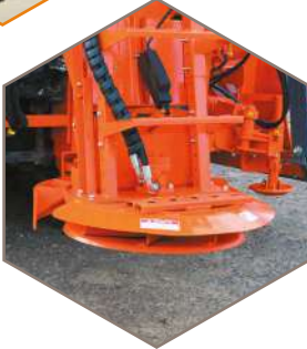
Конусообразная тарелка Ø 600 мм при меньшей скорости вращения позволяет разбрасывать смесь на большую ширину
