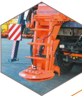
Асимметрия распределения - изменение ширины и направления разбрасывания противогололедных материалов
