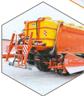
Емкость может устанавливаться на шасси или в кузов самосвала, а также на раму тракторного прицепа
