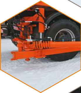
Предохранительная пружина гидроцилиндра и срезной болт для защиты от перегрузок
