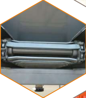
Цепь транспортера движется в закрытом канале. Не требует обслуживания и смазки. Запас ресурса цепи рассчитан на весь срок службы машины
