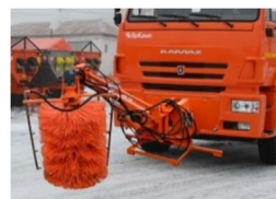
Щетка для мойки дорожных ограждений ЩМБУ
