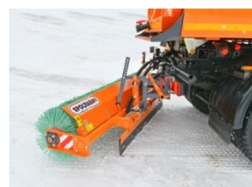
Щетка для мойки дорожных ограждений ЩМБУ
