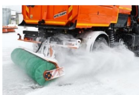
Щетка для мойки дорожных ограждений ЩМБУ
