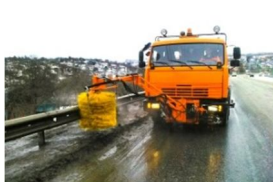
Щетка для мойки дорожных ограждений ЩМБУ
